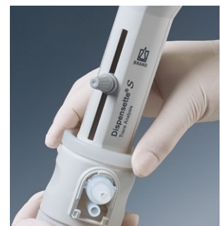
Remplacement facile de l'unité de distribution complète sans outil - l'unité de distribution est calibrée de manière fixe et définitive.
