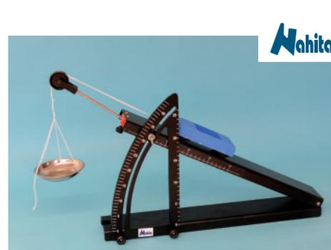
1 | Constitué de 2 plaques métalliques articulées l'une à l'autre à une extrémité ; une plaque sert de base et l'autre de plan incliné.
