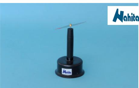
1 | Base circulaire en bakélite avec pilier non magnétique et support en acier au carbone sur lequel pivote l'aiguille.
