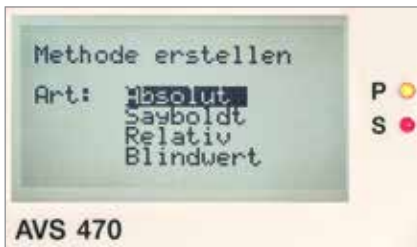
Les paramètres peuvent être adaptés suivant la méthode de mesure. Le temps d'écoulement t_0 peut être déterminé automatiquement.
